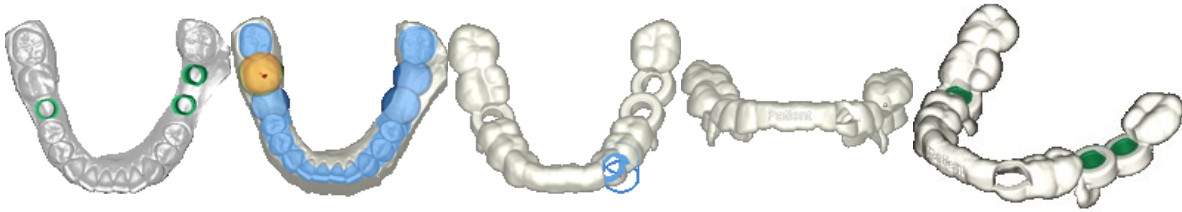
Imagen 2. Dirección de inserción, Superficies de contacto, Ventanas de inspección opcionales, Grabado opcional, Plantilla finalizada
